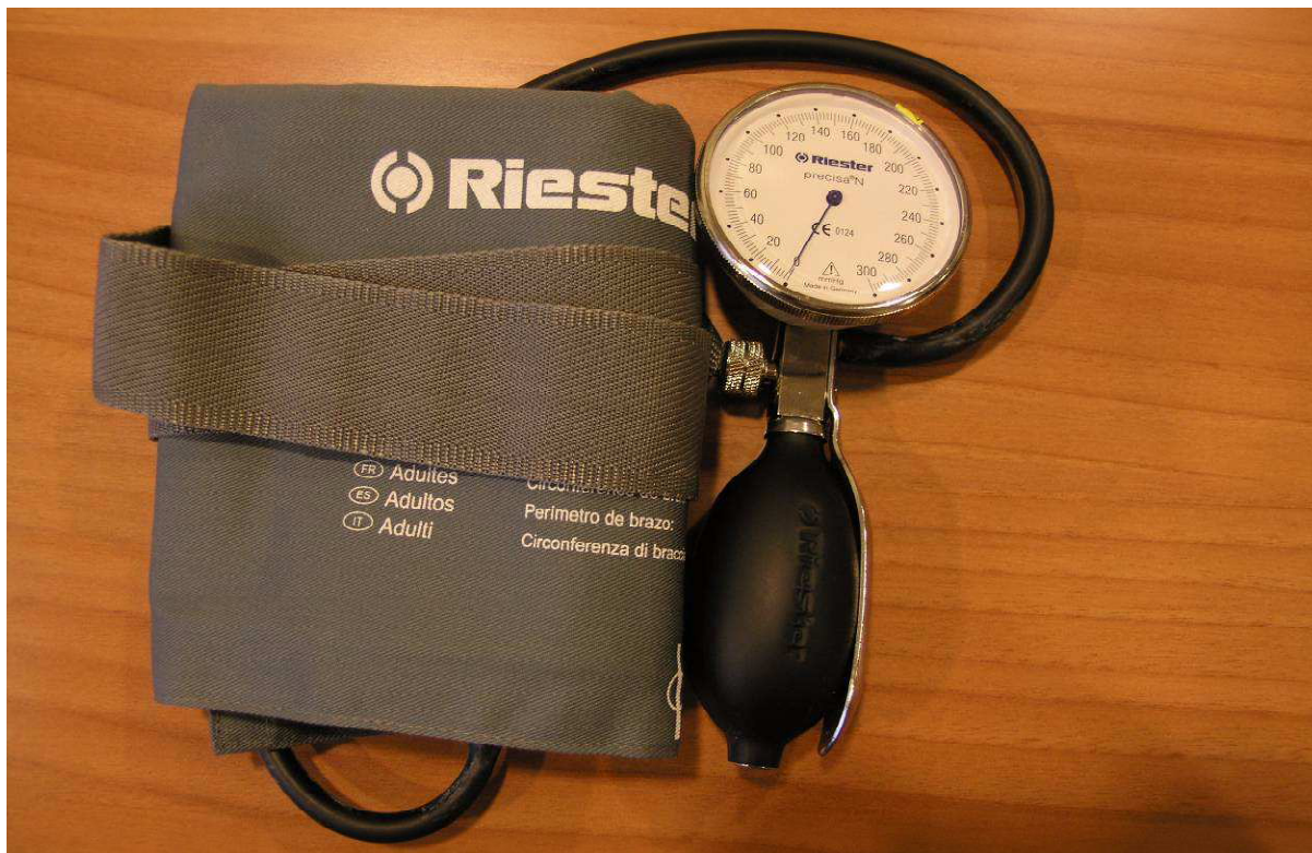
Slika 1: Izgled tlakomjera precisa N s gumenom loptom za napuhavanje i manžetom za ruku
