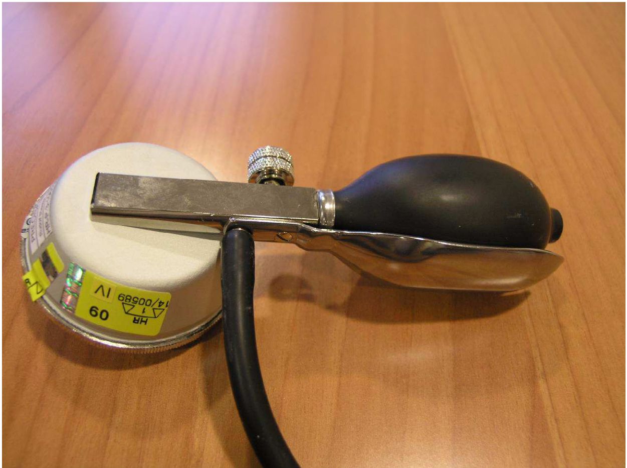
Slika 3: Zaštita od neovlaštena pristupa i smještaj oznake za ovjeravanje mjerila u obliku naljepnice
